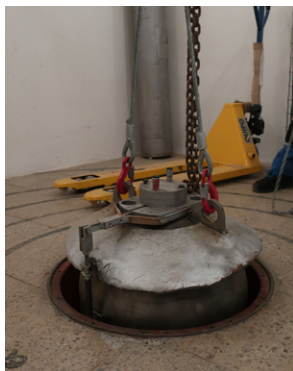
I Výměna zdroje ionizujícího záření v radiační komoře KOP
